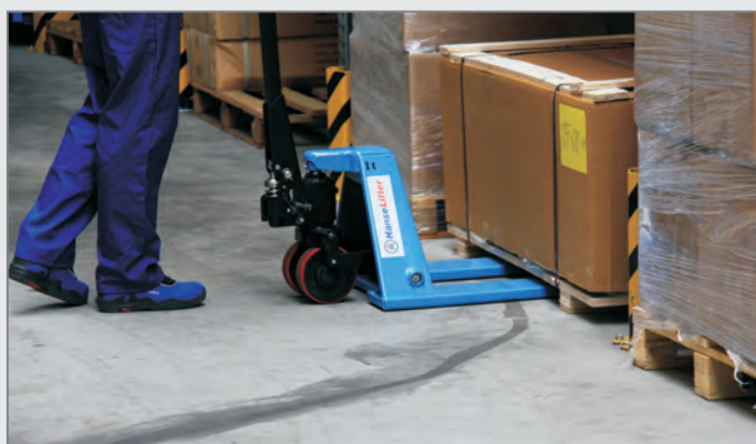
Der BF-L hebt bei einer Mindestgabelhöhe von 35mm auch Spezialpaletten einfach an.
