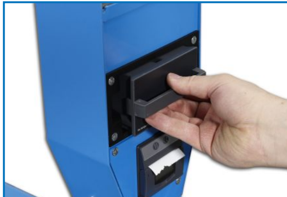
Die Modelle der WHP-Reihe sind mit Wechselakkus ausgestattet, die sich in wenigen Sekunden austauschen lassen.
